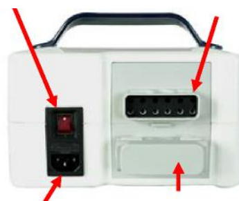
Suministro de corriente
